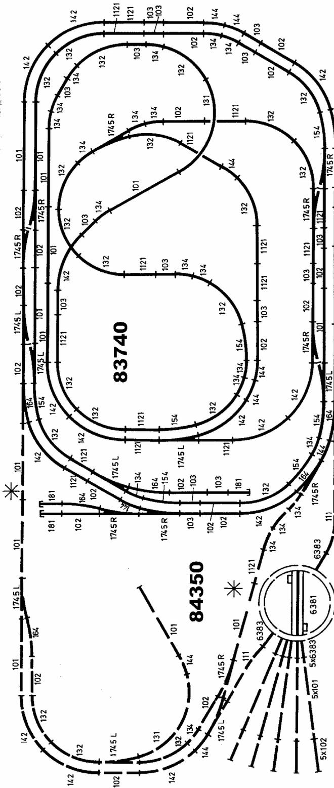
Bei Anschluß der Erweiterung auftretende Längendifferenzen sind durch kurze Gleisstücke auszugleichen.
