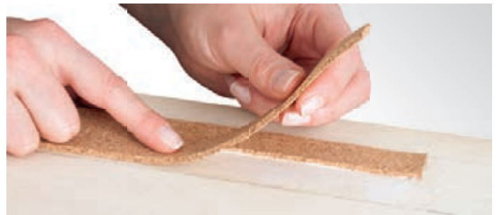
und die beiden dadurch entstandenen Streifen werden anschließend mit den „Rücken“ aneinandergeklebt. Die Kork-Gleisbettungen lassen sich dadurch flexibel verlegen und folgen jedem Streckenverlauf.
