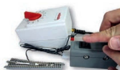
Weichenanschluss an Trafos anderer Hersteller (hier: Märklin®)
