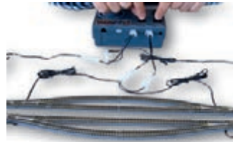
Anschluss von 4 Weichen am „RC03“ mit Hilfe des Y-Kabels (Art.-Nr. 7297405)
