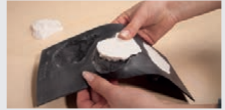
Nach dem Aushärten wird der Einzelfels vorsichtig aus der Form gedrückt.
