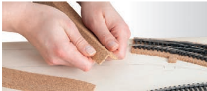
Zunächst wird die Kork-Gleisbettung in der Mitte auseinandergeknickt ...
