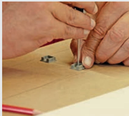
2. An den Schnittstellen der Fahrtrassen werden Bodenplatten für die Pfeiler aufgeschraubt.
