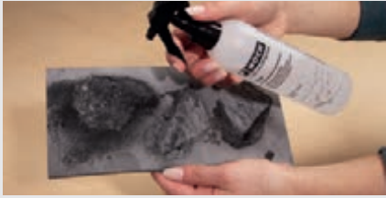
Die Fels-Gussform wird mit einem Trennmittel aus Wasser und Spülmittel (20:1) eingesprüht.
